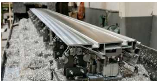
Фрезерование поверхности каретки
