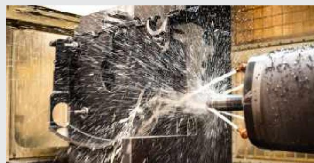
ЧПУ-обработка чугуного пыльного узла
