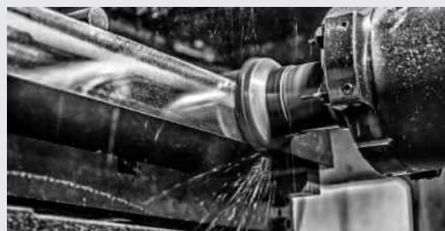
Фрезерование кромки чугуного стола
